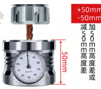
将 Z 轴设定仪置于工件上, 刀具接触测量面, 请慢速进刀使指针指在“0”则刀具与上把刀具距离同等, 与工件的高度差距离是 550\text{mm}
